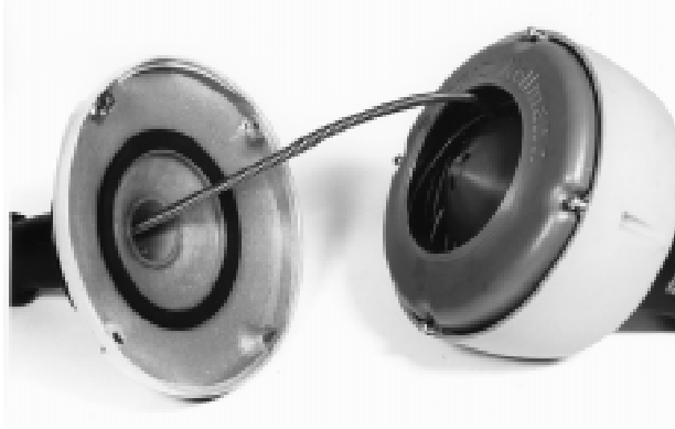
Figura 2 – Solte os quatro parafusos da parte de trás do recipiente umas 2 voltas.
