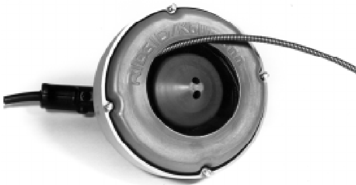
Figura 3) – Ao instalar o cabo no tambor interno, gire o cabo em sentido horário.
