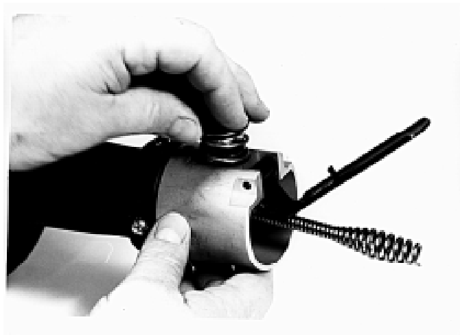
Figura 16 –Alavanca do alimentador aberto para cima.
