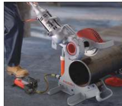
Modelo 258 utilizando uma 700 PD para corte.
