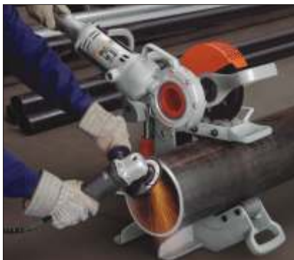
Modelo 258 usando o Rolo para biselar tubos Dois operadores são recomendados nesta operação.
