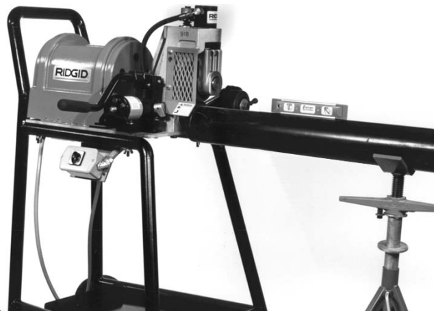
Figura 6 – Alinhamento do tubo no suporte do tubo e ranhuradora de tubo 918-I
