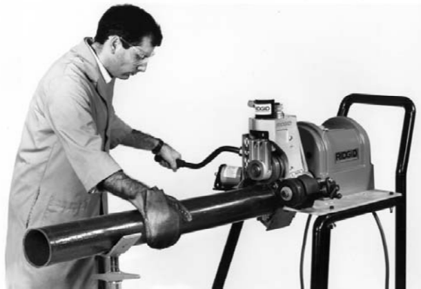
Figura 9 – Ranhura de tubo exercendo pressão manual leve em direção ao operador
