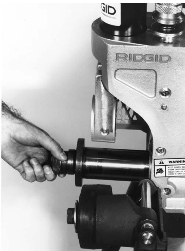
Figura 15 – Remoção do eixo de acionamento
