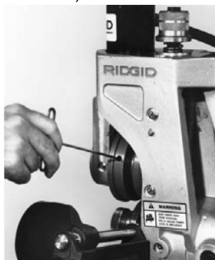
Figura 11 – Afrouxe o parafuso de ajuste do rolete de ranhura
