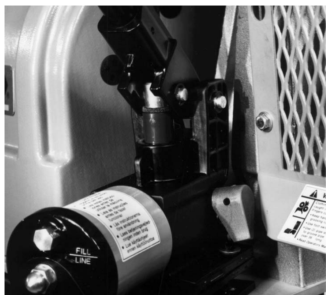
Figura 4 – Close - alavanca de liberação da bomba 918-I
