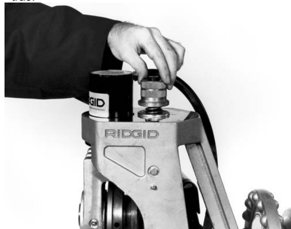
Figura 8 – Close do botão de ajuste de profundidade sendo girado contra o topo
