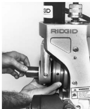
Figura 12 – Remova o eixo e o rolete de ranhura
