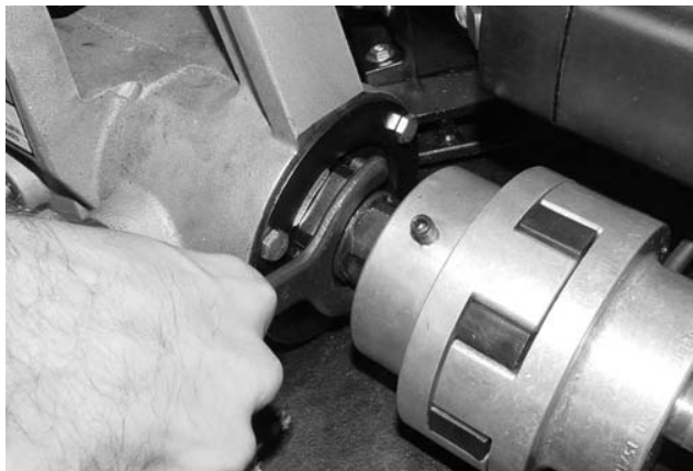
Figura 14 – Afrouxe o remova a porca de fixação do eixo de acionamento
