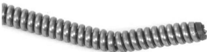
**Figura 15 – Curva na extremidade do cabo**
