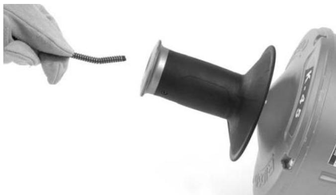
**Figura 17 – Colocação do cabo sem trocar o tambor interno**
