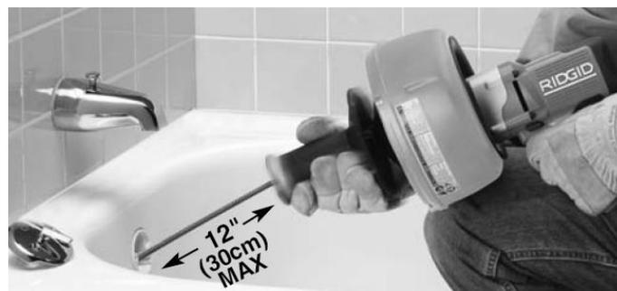
Figura 8 – Mova o punho na direção do tambor para segurar o cabo com o mandril
