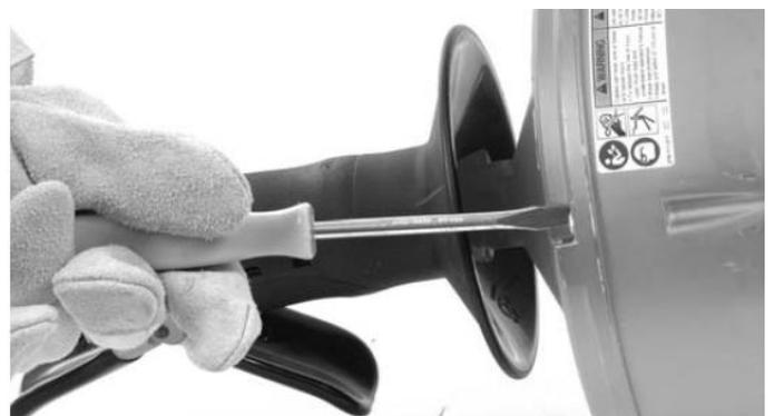
Figura 13 – Afrouxe 4 parafusos do tambor em cerca de 3 voltas completas, sem retirar
