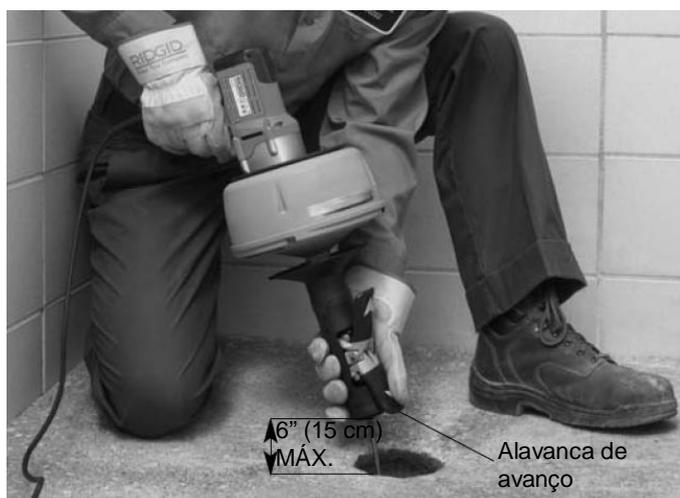
Figura 10 – Passando o cabo com AUTOFEED
