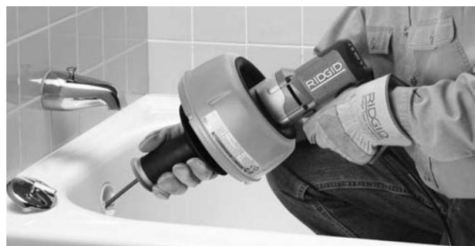
Figura 9 – Empurre o cabo para a tubulação do tubo
