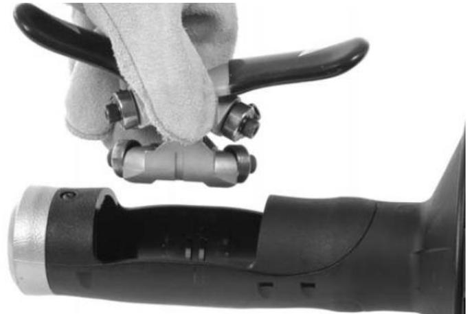
Figura 12B – Retirada do mecanismo móvel de AUTOFEED da carcaça
