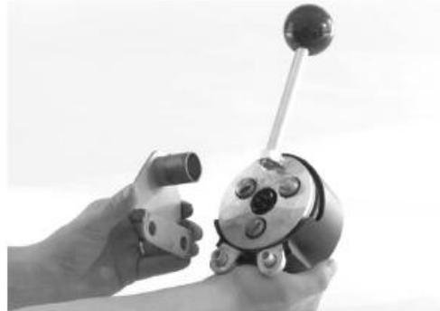
**Figura 3 - Instalação do suporte de montagem no AUTOFEED**
