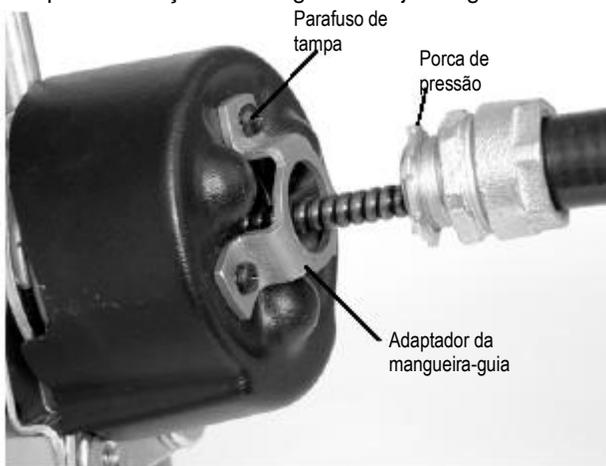
Figura 5 - Montagem da mangueira-guia no AUTOFEED
