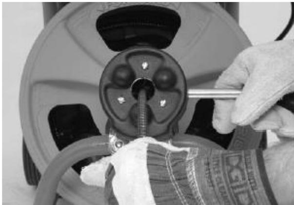
Figura 14 - AUTOFEED na posição de retirada
