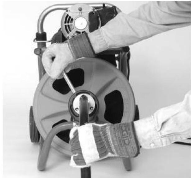
**Figura 15 - Utilização da máquina com mangueira-guia**
