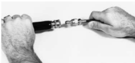
Figura 3 – Conexão da mangueira na jateadora
