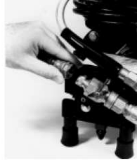
Figura 2 – Conexão da Mangueira de Abastecimento de Água na Jateadora. Fechamento da Válvula de Alimentação de Entrada (mostrada na posição fechada).
