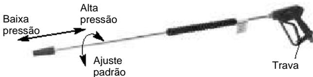
**Figura 17 – Ajustes do bocal do cano de lavagem**
