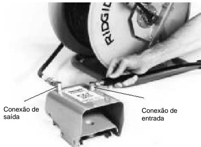
Figura 11 – Conexão da válvula de pé
