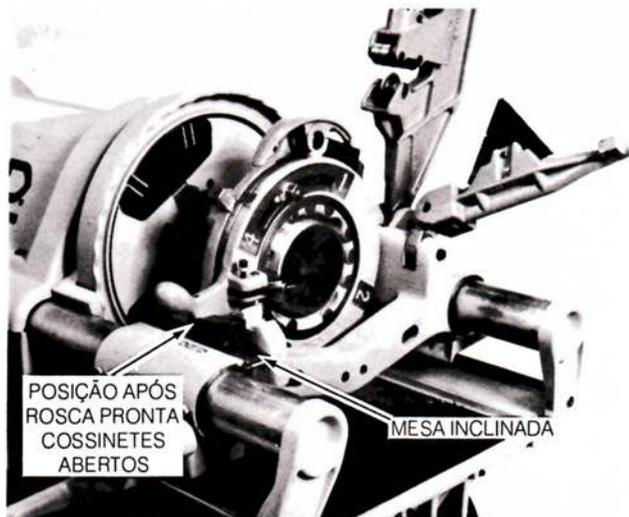
FIG. Nº 14 - A extremidade do tubo acionando o gatilho, disparando e abrindo os cossinetes. Cabeçote 714 ou 914.
