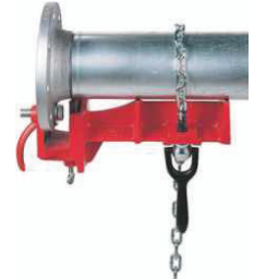
Solda de Flanges em Tubos
