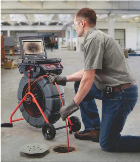
O SeeSnake® LT1000 interface para Laptop permite que se incremente a capacidade e a flexibilidade de um Laptop com um sistema de rodas SeeSnake. Usando um Laptop como um monitor, suas opções de gravação e monitoramento serão tão poderosas quanto de um PC. Gravação Digital. Gravação de DVD, transmissão sem fio e hospedagem on-line são possíveis com o LT1000 e o Laptop. Emparelhados com um Laptop robusto, o LT1000 é o sistema mais poderoso e flexível do Mercado.
